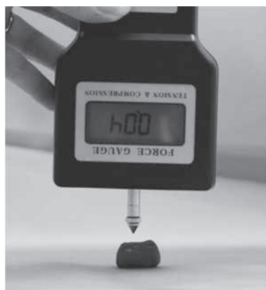
図 3 粘土の硬度測定
